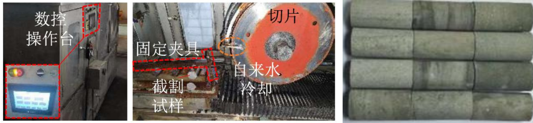
图 2 顶板岩样制备
